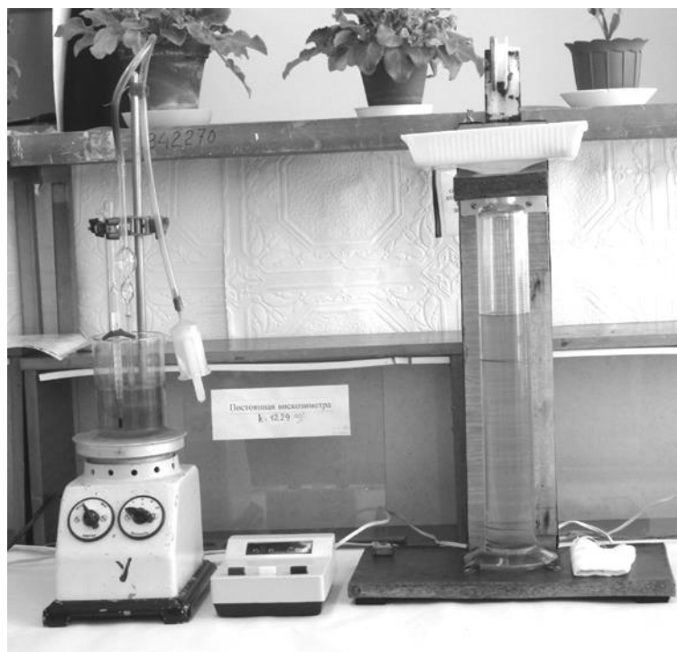
Рис. 3.3. Вид установки для определения вязкости жидкости с помощью вискозиметра (слева) и методом Стокса (справа)
