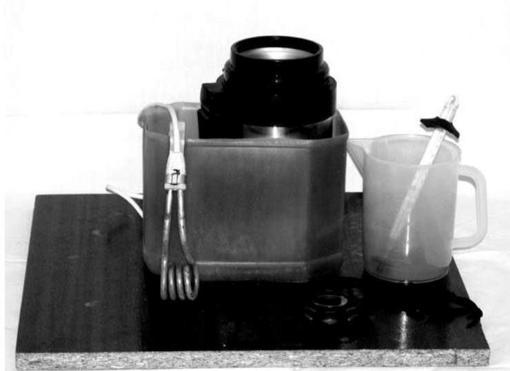
Рис. 8.1. Лабораторная установка для определения удельной теплоемкости и удельной теплоты парообразования воды
